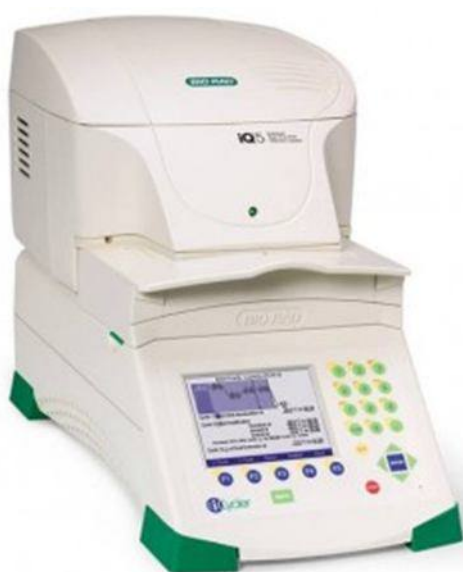
Рис. 68. Амплификатор iQ (Biorad). Прибор может быть использован как для ПЦР в реальном времени, так и для обычной (конвенционной) ПЦР
